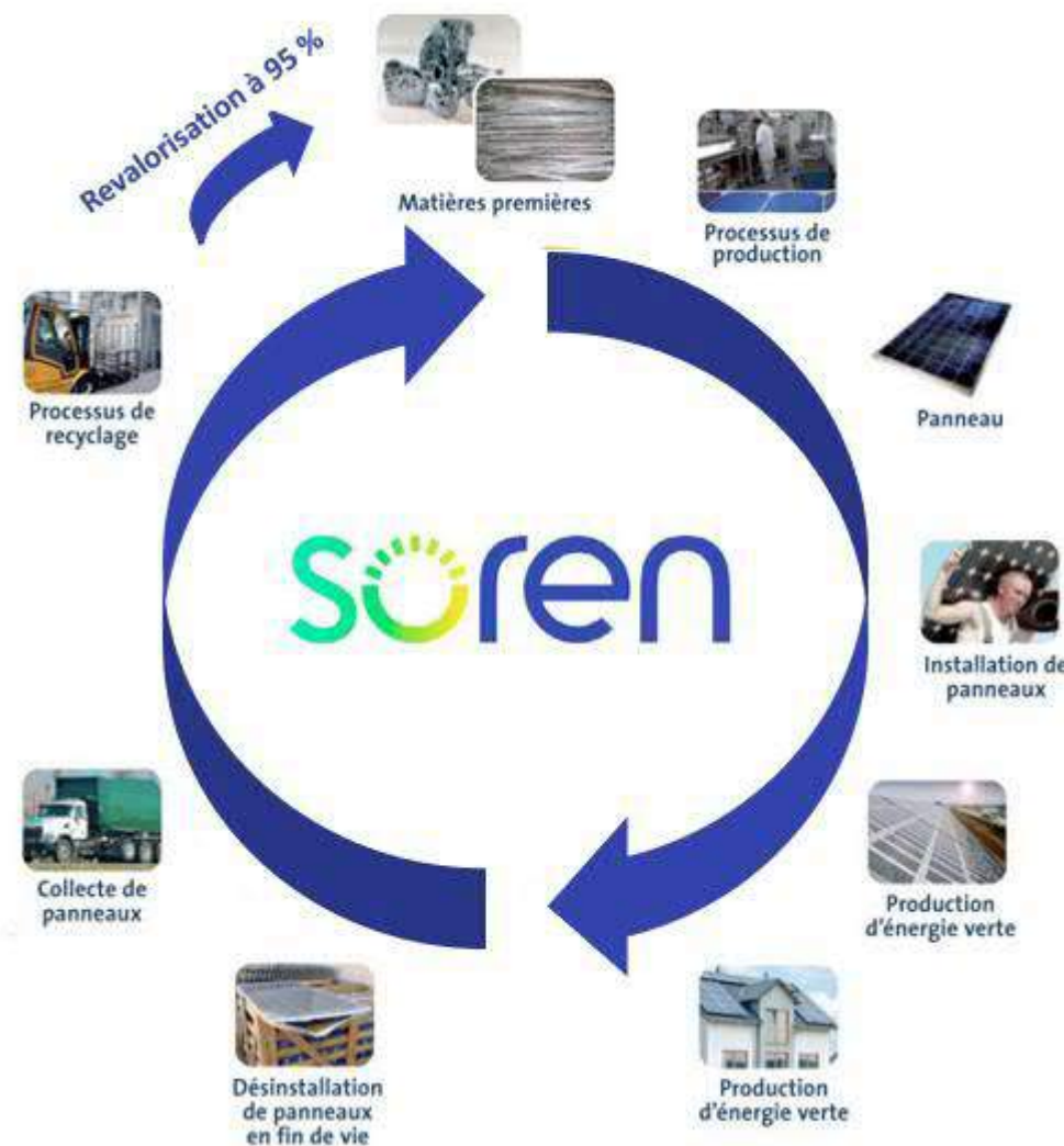
Analyse du cycle de vie des panneaux photovoltaïques en silicium cristallin (source : PV Cycle, aujourd'hui SOREN)
