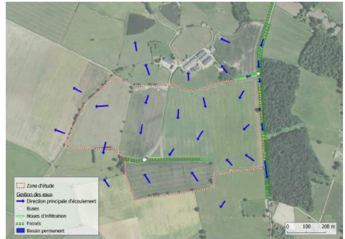
Gestion des eaux et fonctionnement hydrologique au droit de la zone d'étude (MICA Environnement)
