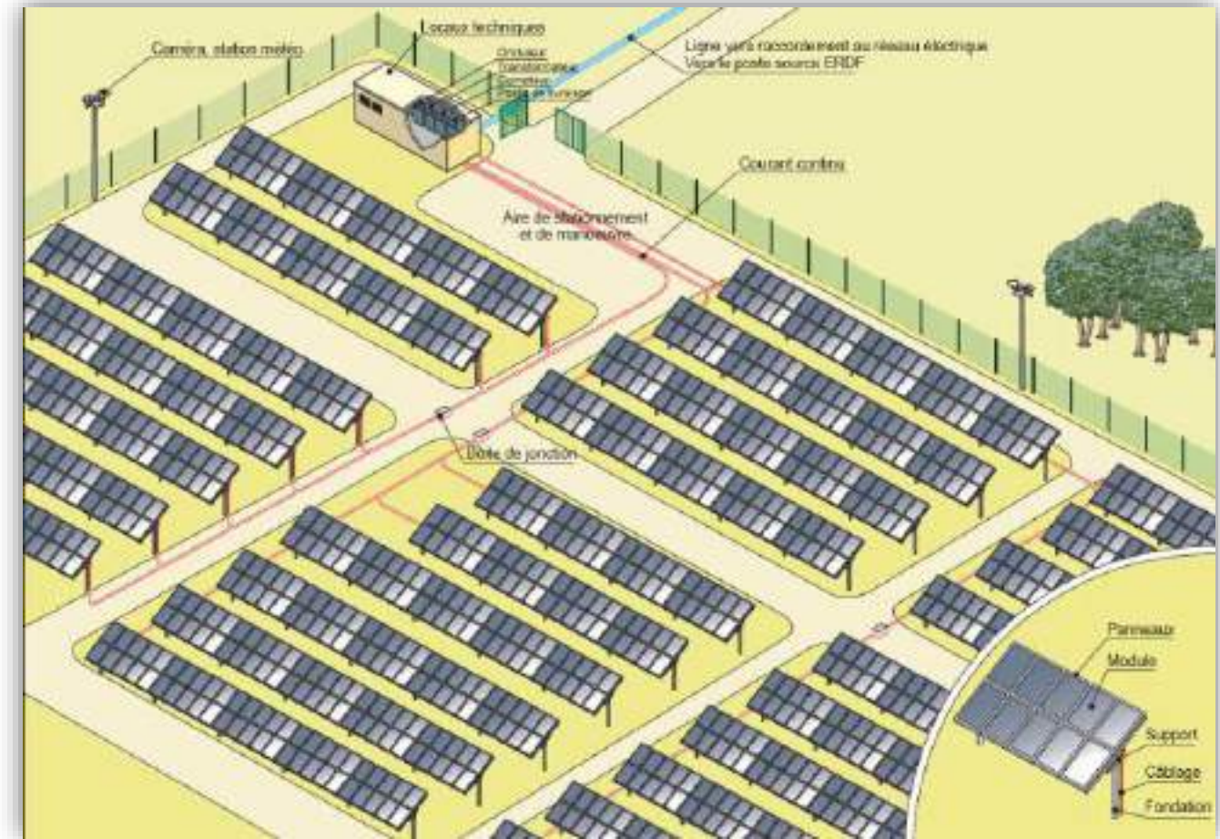
Principe d'implantation d'une centrale solaire
